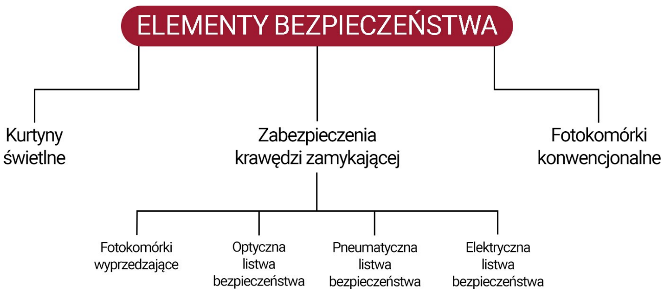
Rys. 3. Podział elementów bezpieczeństwa w bramach
